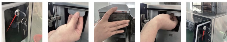
Установка емкости для кофейных зерен завершена.
