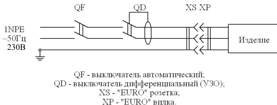
Рис. 1. Схема подключения изделия к электросети.
